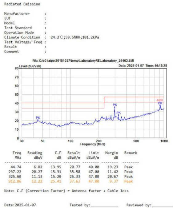
图 4-5 RE 测试水平方向
